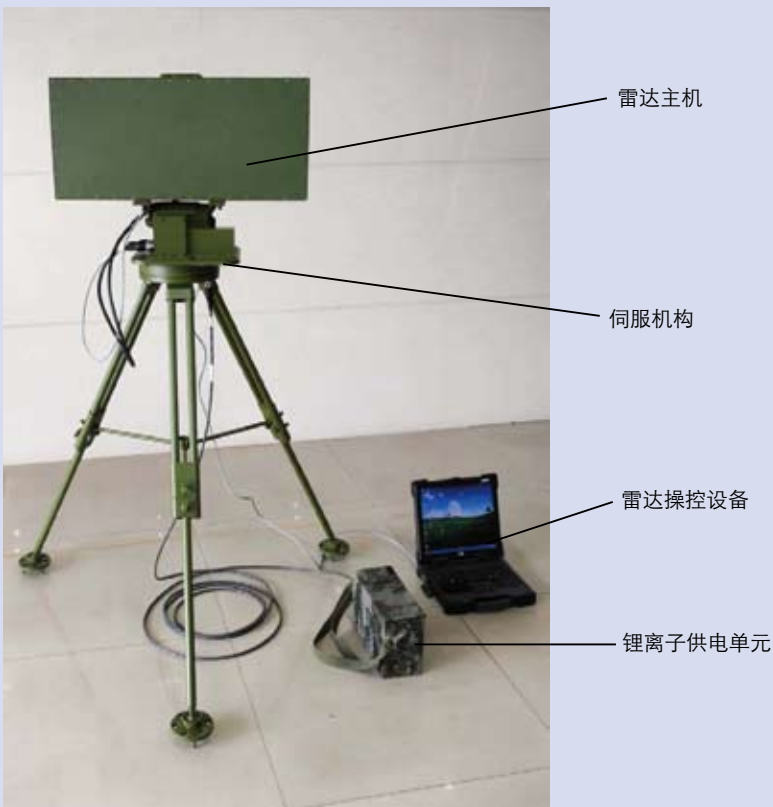
• 雷达监测系统 Radar monitoring system
